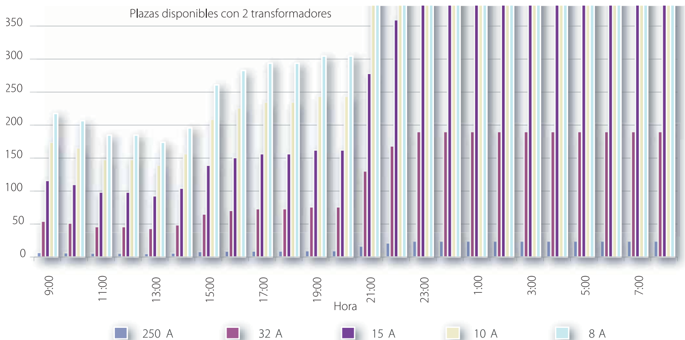
Gráfico VI.02. Plazas disponibles utilizando los 2 transformadores de 1.250 kVA
