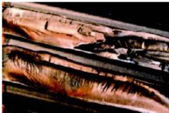
Figura 21: Daños en dientes multiplicadora.
