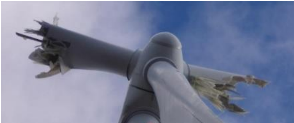
Figura 17: buje con palas rotas
