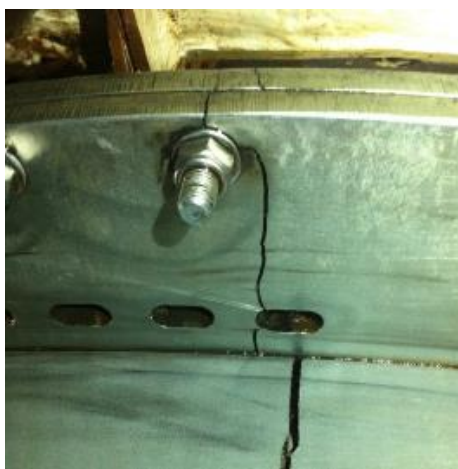
Figura 18: grietas en rodamiento de pala.
