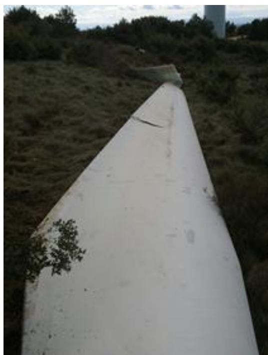
Figura 16: pala desprendida por la raíz.
