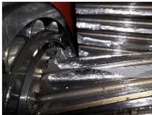
Figura 21: Daños en dientes multiplicadora.
