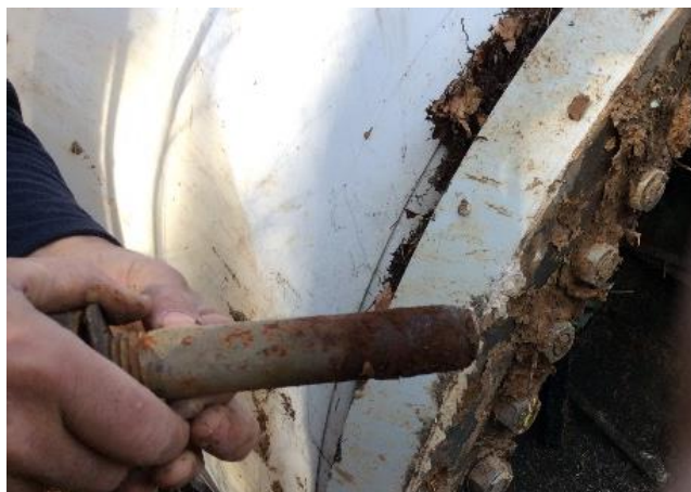
Figura 19: desprendimiento de pala por rotura de pernos
