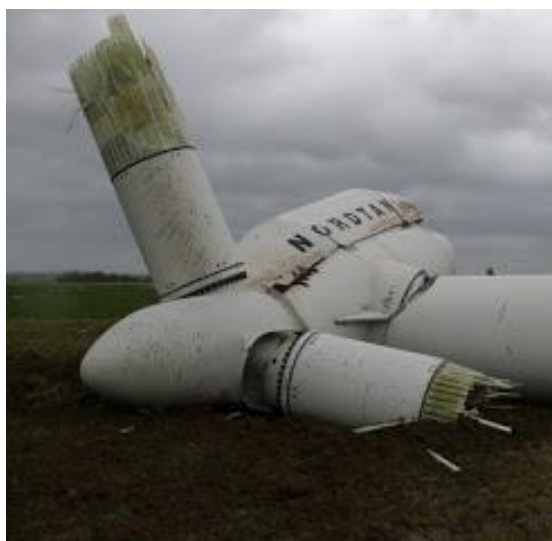
Figura 16: aerogenerador siniestrado en el suelo.
