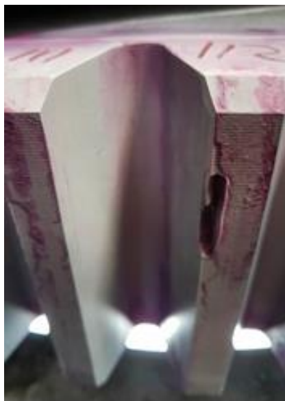
Figura 11: Grietas en corona. Líquidos penetrantes.
