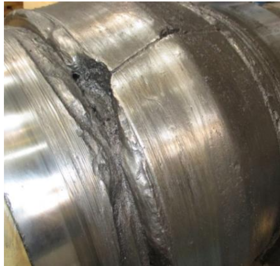
Figura 12 : rodamiento principal dañado.
