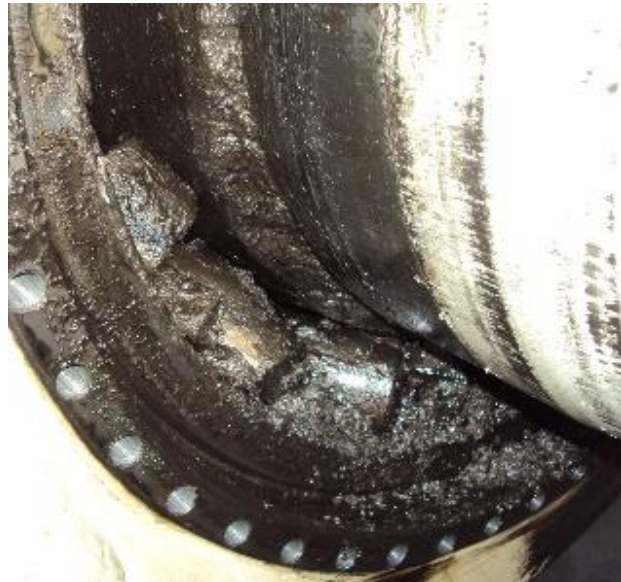
Figura 20: Daños en rodamientos de eje principal.
