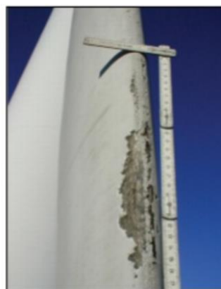
Figura 4: Daño típico en el borde de ataque de la pala (Fuente: INGETEAM/Skillwind)
