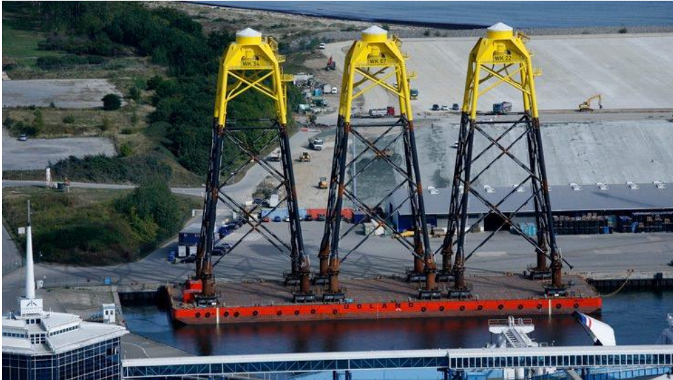
Figura 3: Cimentación fija tipo Jacket para el parque eólico marino de Wikinger, Alemania (Fuente: Iberdrola).
