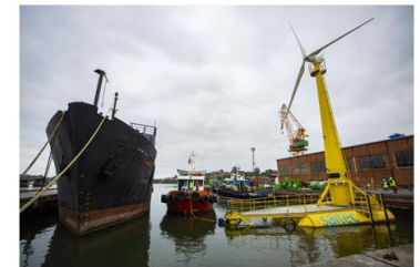
SAITEC - SATH. Tecnología flotante Barge. Prototipo 1:6 ensayado en Santander (2020)
