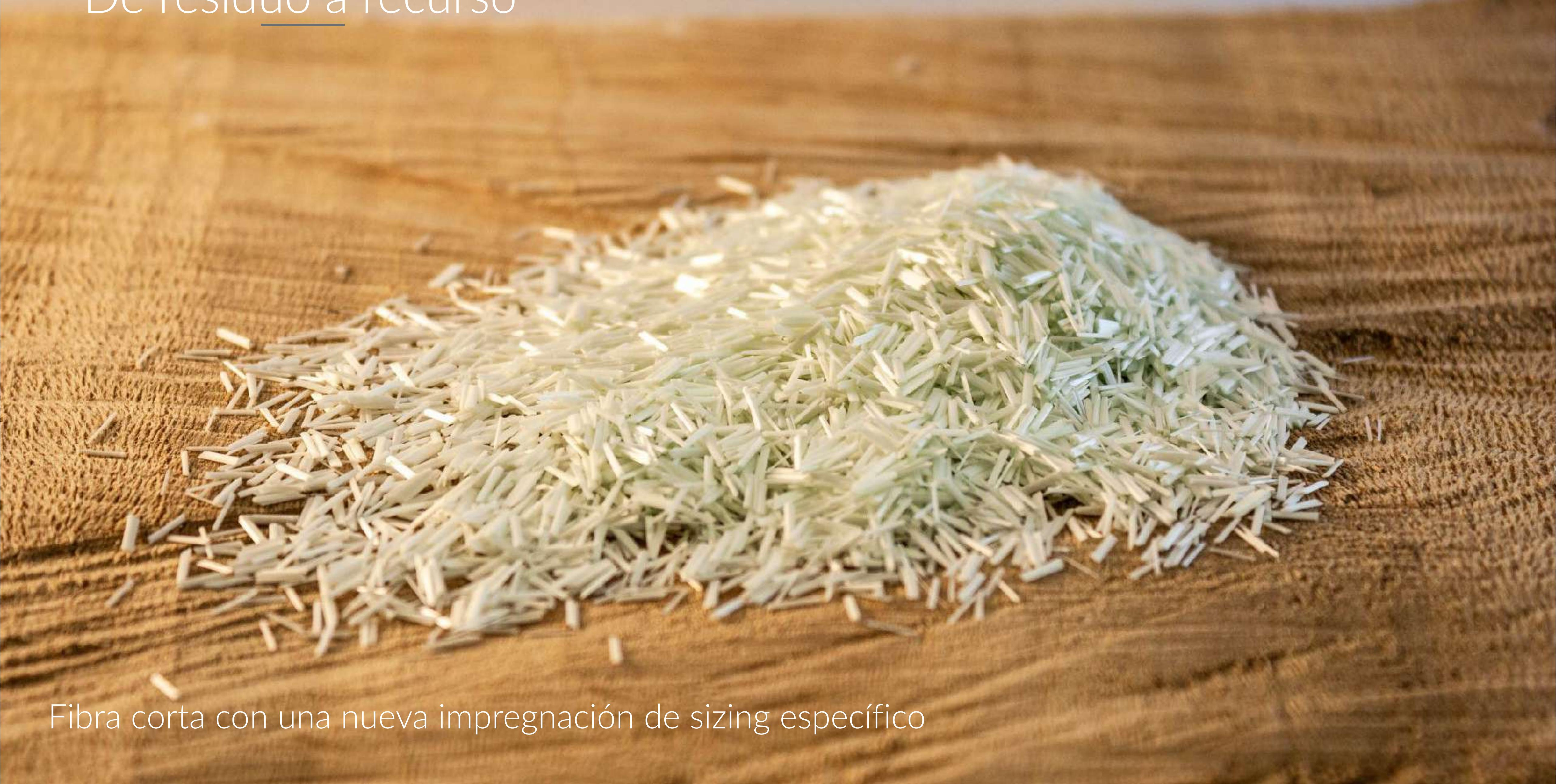
Fibra corta con una nueva impregnación de sizing específico
