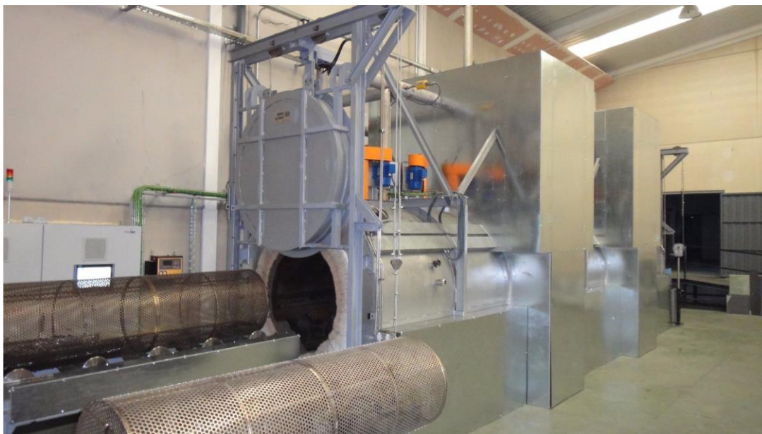
Figura 26: Horno de pirólisis para realizar el reciclado térmico de las palas (Fuente: Reciclalia).
