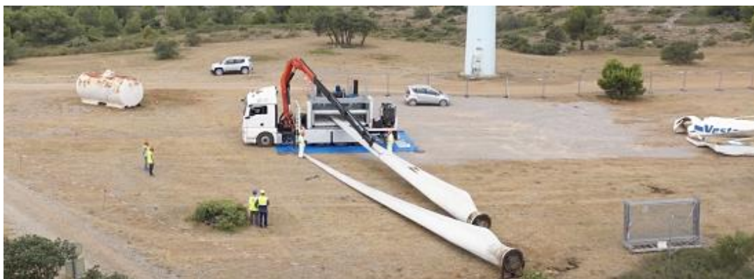
Figura 27: Mecanizado de las palas in-situ, para prepararlas para su posterior tratamiento térmico (Reciclalia, 2017).
