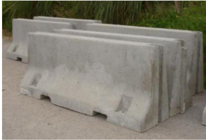
Figura 21: Prefabricado de hormigón a partir de material de palas (LIFE+BRIO, 2017).
