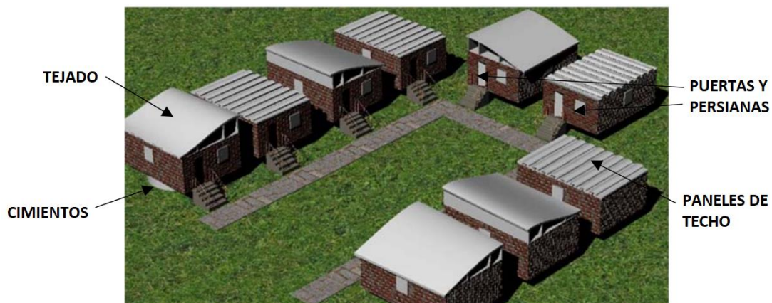
Figura 19: Aplicación de palas de aerogeneradores desmanteladas para techados (Gentry, et al., 2020)
