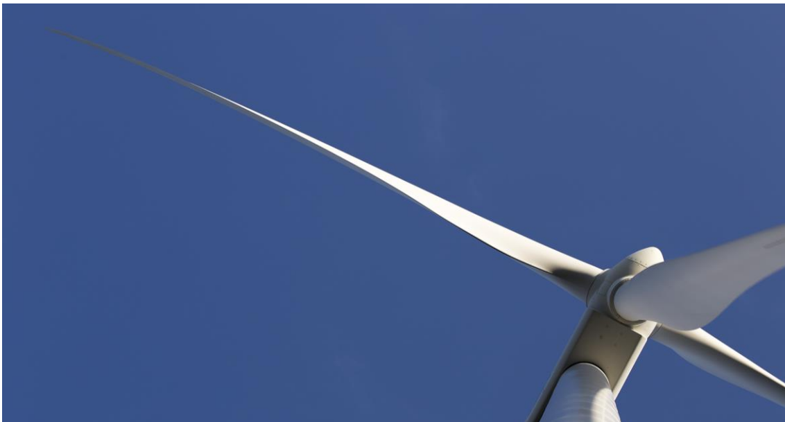
Figura 7: Las palas son generalmente fabricadas a partir de materiales compuestos PRFV con resinas termoestables (Autor: R. Andrés).
