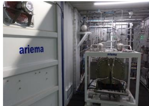
Electrolizador containerizado. Proyecto Aurora (Sacyr), 2017
