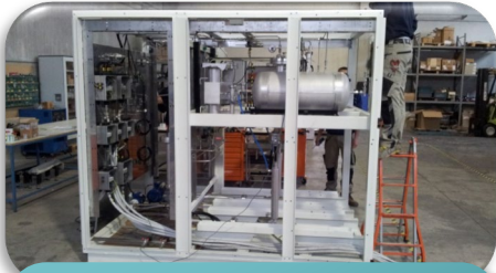
Lab Uni Huelva Electrolizador de 2Nm 3 /h Almacenamiento a presión y en hidruros metálicos Pilas de combustible Aerogenerador Seguidor solar y paneles PV
