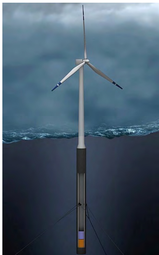
Ilustración 8. Simulación prototipo Plataforma WindCrete.
