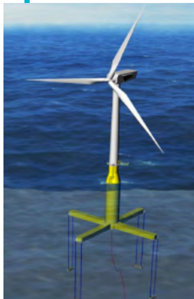
Ilustración 3. Simulación prototipo Plataforma TLPWind.
