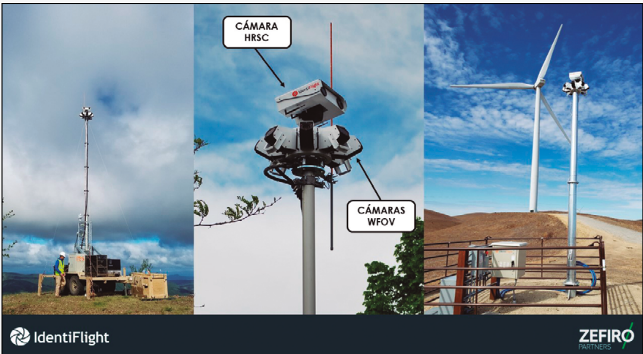
Figura 1. Detalle del módulo con los sensores ópticos de IdentiFlight (centro) y vista general de una posición móvil (izquierda) y de una fija (derecha).
