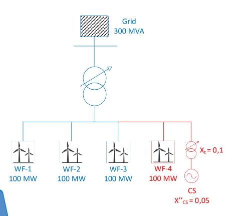
$$Capacidad \ MPE \ adicional \ (MW) = \frac{S_{cc \ aportada \ SC}}{umbral \ WSCR \ del \ nudo}$$
