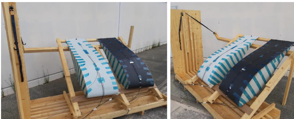
Figura 7: Ensayo de envejecimiento natural de dos secciones de pala.
