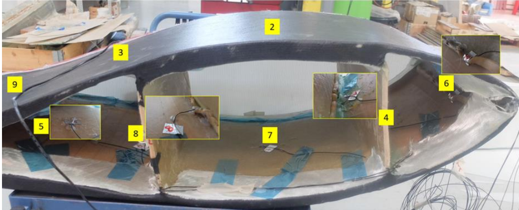
Figura 8: Sección de pala pintada de negro con 8 termopares.
