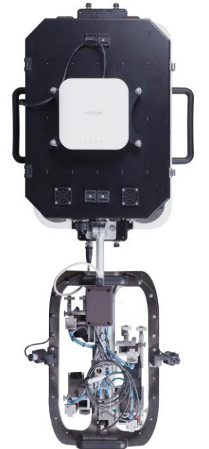
KRATOS: Inspección de soldaduras
