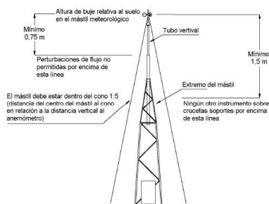
Figura G.1 – Ejemplo de un anemómetro montado en extremo de mástil y requisitos para su montaje
